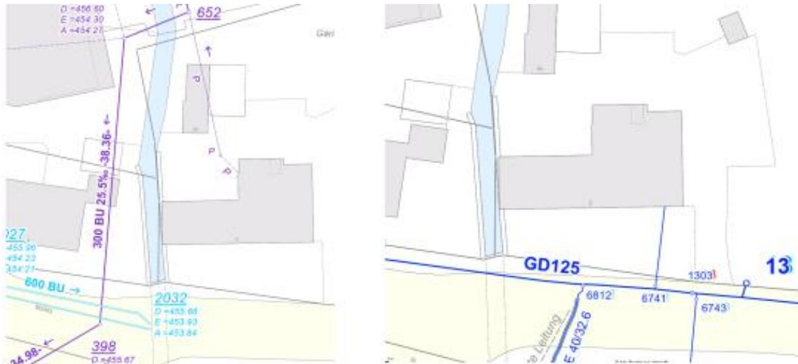
Abbildung 21: Werkleitungsplan Abwasser (links) und Trinkwasser (rechts), InfoGis März 2021
